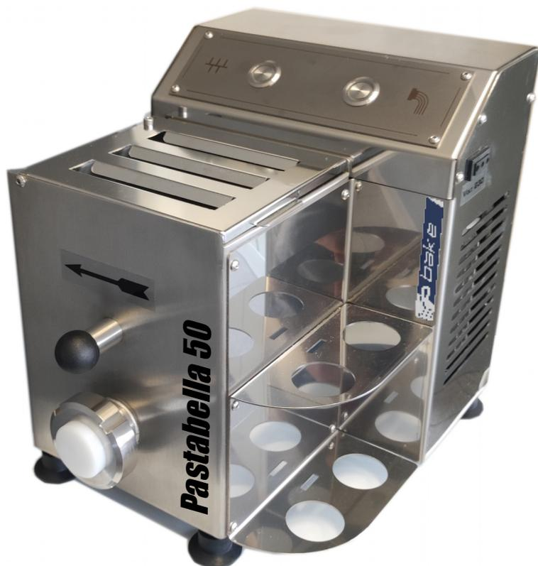
*Macchina per la produzione di pasta fresca di vario tipo, con mescolatore e coclea di estrusione, adatta a piccole realtà o per uso domestico, con produzione oraria massima di 5 Kg e capacità vasca pari a 1,8 Kg.*
